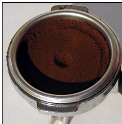
On voit l'empreinte de la vis, ce qui veut dire qu'il y a trop de café.
